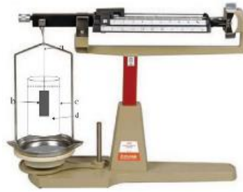
Gambar 7. Skema pengujian metode 1 Hukum Archimedes
